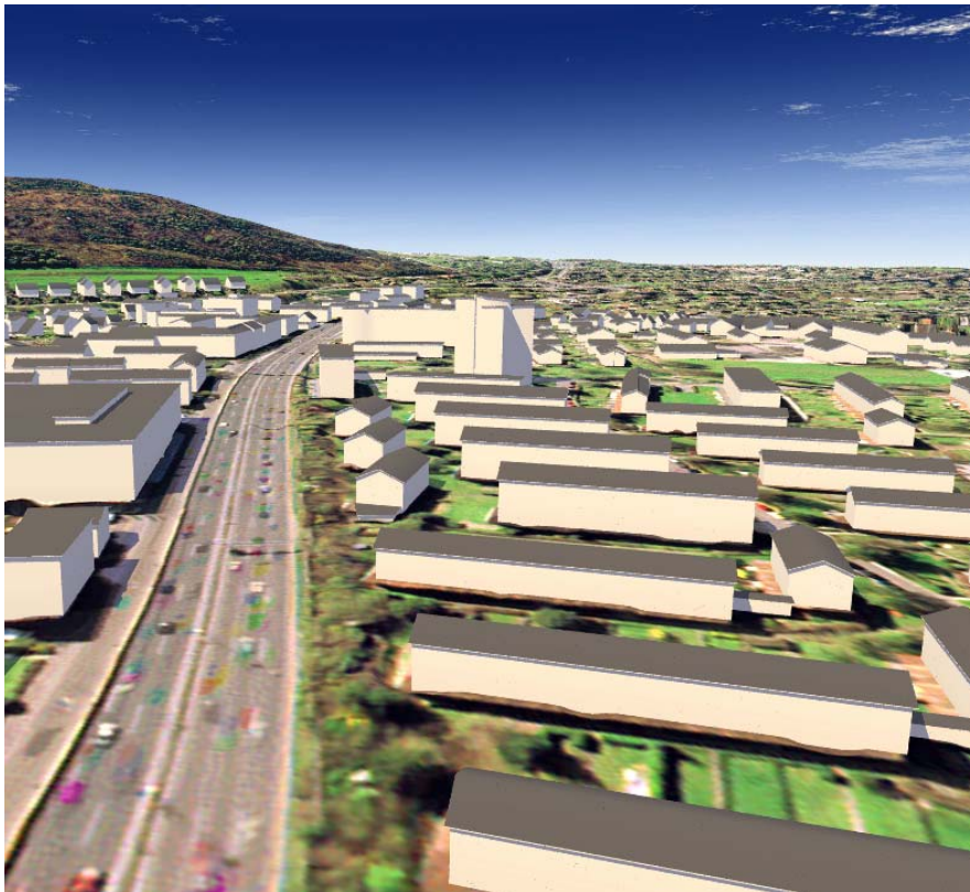
Abbildung 6: Kombination von Gebäudemodellen aus DOM, True Orthophoto und DTM
