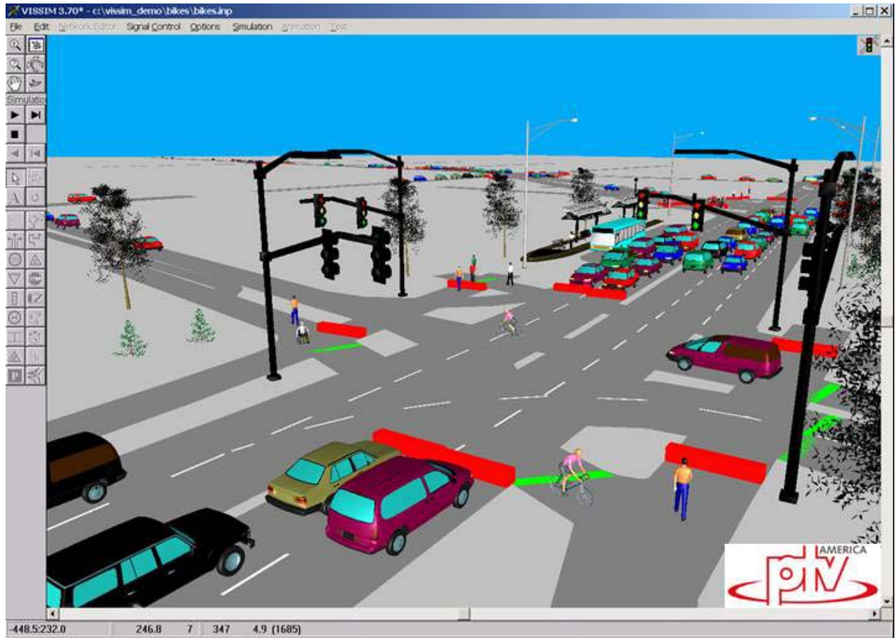
Abb.12: Veranschaulichung der Berechnungsergebnisse durch 4d-Simulation mit VISSIM (Quelle: PTV America)
