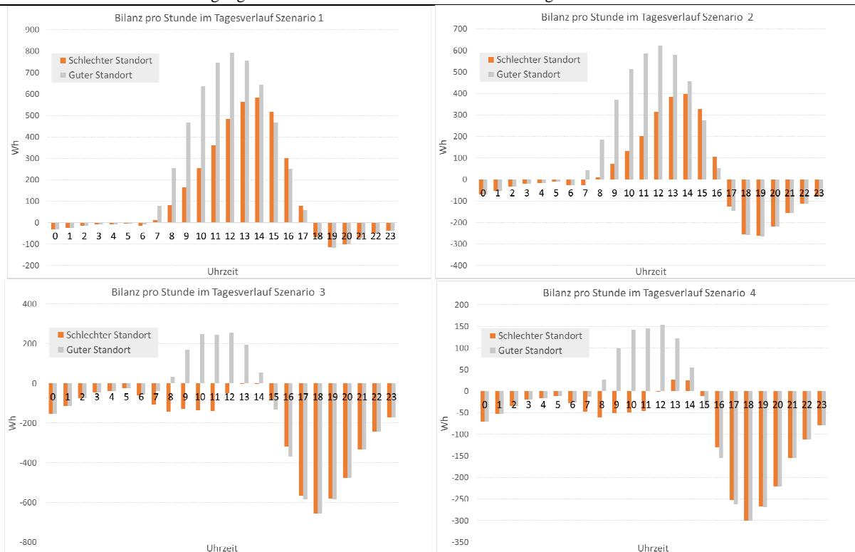
Abb. 9: Szenariovergleich der Bilanz pro Stunde im Tagesverlauf der Solaren Stromproduktion minus Verbrauch durch E-Bikes (Source: Berechnungen AIT)
