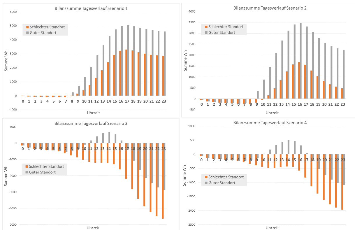
Abb. 10: Vergleich der Bilanz der solaren Stromproduktion minus Verbrauch von E-Bikes verschiedener Szenarien (Quelle: Berechnungen AIT)
