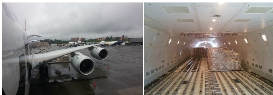
Abb. 11 u. 12: Die Befrachtung eines Frachtflugzeuges B 747F mit ULDs auf dem Cargo-Vorfeld
